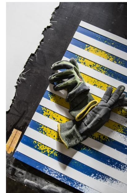
la CNC (fraisage à commande numérique). En creusant dans la matière composite, se révèlent peu à peu les différentes couches de gelcoat, la résine, les fibres tissées ou non tissées, et ainsi les gestes artisanaux cachés derrière la surface lisse.
