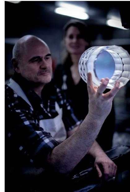
En 2017, l'atelier du chaud (l'atelier de soufflage) était à l'arrêt au Val Saint-Lambert. **Annick Schotte** a, de ce fait, principalement étudié et expérimenté la taille sur des pièces existantes avec l'atelier du froid et, plus spécifiquement, avec **Michel Bouckellyoen**, tailleur et **Alain Hack**, polisseur. Taille et polissage sont des traits caractéristiques de la production du Val qui requièrent une grande expérience et la maîtrise des gestes.
